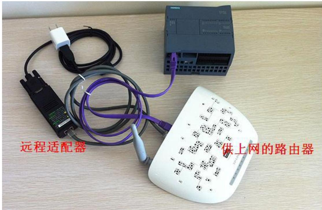
如图所示，将远程适配器和 PLC 都连接到一个可以上网的路由器上，并且对远程适配器进行 5V 供电(这里我是用手机充电器的适配器供电的,你也可以用电脑的 USB 口之类的其他供电方式)。
