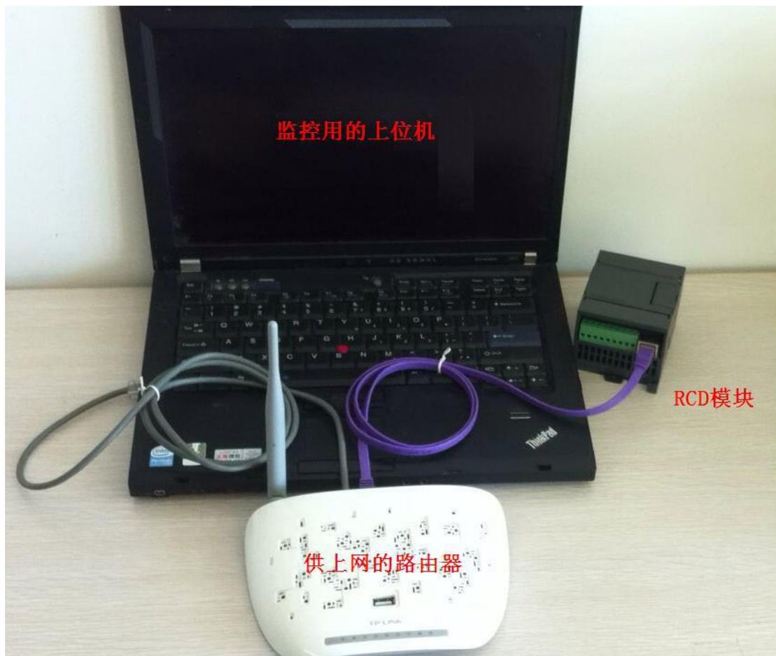
按照上图连接各个硬件，并对 RCD 模块 24V 供电。
